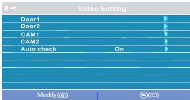
Параметры «Панель1», «Панель2», «Камера1» и «Камера2» используются для указания стандарта, разрешения и формата видеосигнала по выбранному каналу вручную. Выберите нужный канал и нажмите на кнопку «Меню», откроется окно:
