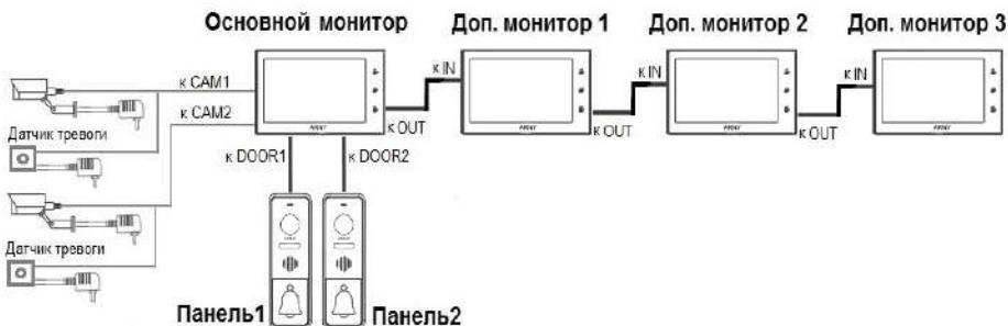
Вызывные панели подключаются только к основному монитору. Корректная работа мониторов в единой сети гарантируется только в том случае, если используются одинаковые мониторы. Подключение всех устройств следует производить только при отключенном питании монитора!
